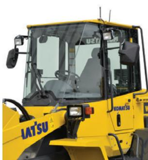
Um amplo vidro de superfície plana e sem colunas proporciona excelente visibilidade frontal. O braço do limpador cobre uma área extensa, possibilitando boa visibilidade até mesmo em dias chuvosos. A área da cabina é a mais espaçosa da categoria, garantindo o máximo de conforto para o operador. O ar condicionado instalado na parte frontal ampliou a praticidade da reclinção do assento e seu deslizamento para trás.
