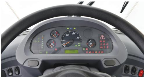
O painel monitor está instalado bem à frente do operador para fácil visualização, possibilitando que o operador verifique de maneira descomplicada os indicadores e luzes de advertência. O volante da direção, especialmente projetado com dois raios de forma a priorizar a visibilidade do painel pelo operador.
