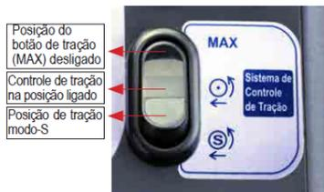
Além desses benefícios, o esforço máximo de tração pode ser ajustado em três estágios (apenas 1 estágio em máquinas convencionais) quando o interruptor de controle de tração está ativado. Isso permite ao operador selecionar o esforço de tração ideal para as mais variadas condições de terreno.
